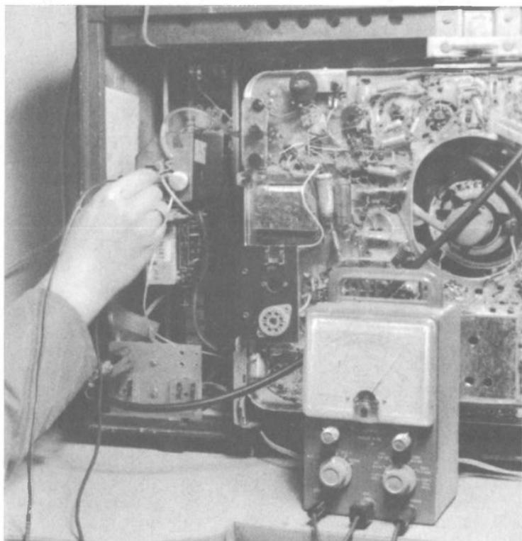
*Bild 3.05–1. Kontrolle des VHF-Oszillators durch Spannungsmessung*
