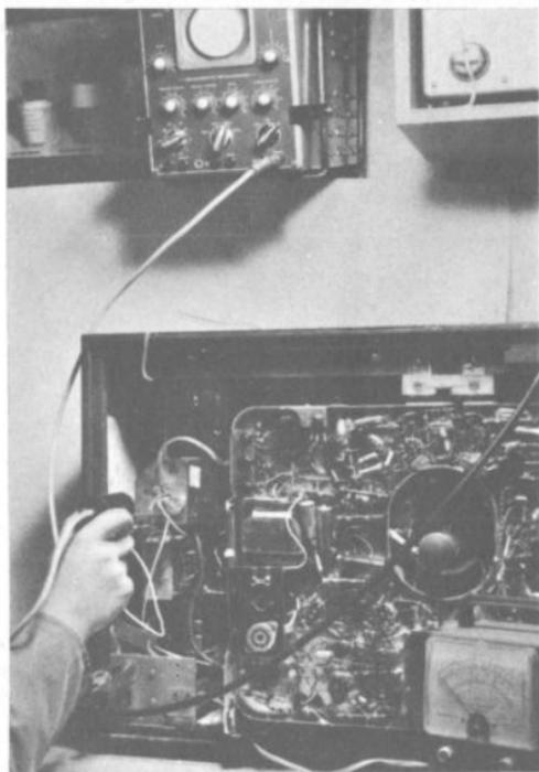
Bild 3.06-1. Kontrolle der VHF-Vorstufe mit Oszillograf
