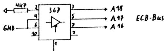
Abb.1: Erzeugen der richtigen Pegel von A16-A18 für die Adressierung der TPA beim Prof 180x bei physikalisch 40000H-4EFFFH
