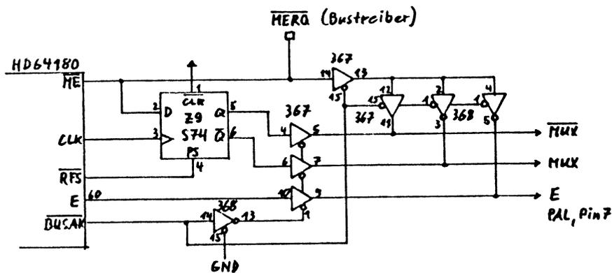
Abb.3: auf einer Adapterplatine im Sockel von 29, 74S74 wird die Umschaltung zwischen den im Prof 180x erzeugten und den aus MERQ\* abgeleiteten RAM-Steuersignalen untergebracht, BUSAK\* regelt die Umschaltung
