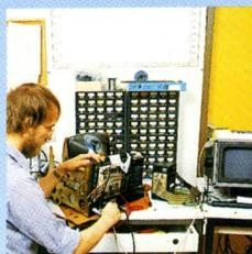
Dieser wird noch durch einen zusätzlichen dreitägigen Burn-in-Zyklus ergänzt. Automatische Testprogramme garantieren, daß dabei alle Funktionen der Geräte angesprochen werden.
