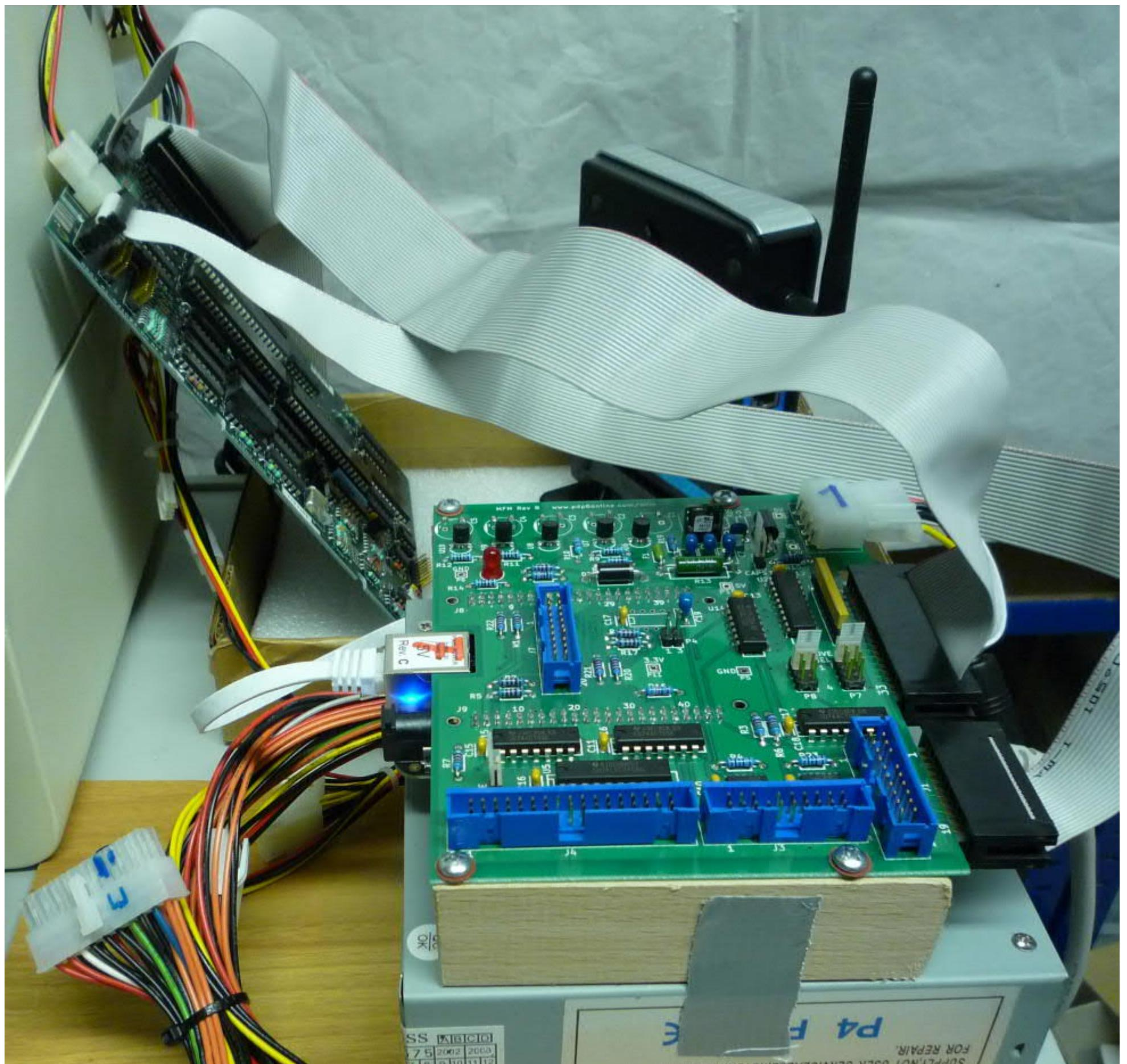
Die Stromversorgung des BeagleBoard geht über den Spannungswandler U12 der 12V nach 5V wandelt. Bei gesetztem CAPS Jumper und leuchtender Diode D2 das BeagleBoard nicht von der MFM-Emu-Platine ab- oder anstecken. Bei defektem Spannungswandler (bei einem meiner MFM Boards war der Spannungswandler U12 defekt und wurde von mir getauscht) kann das BeagleBoard über seine eigene Stromversorgung betrieben werden.
