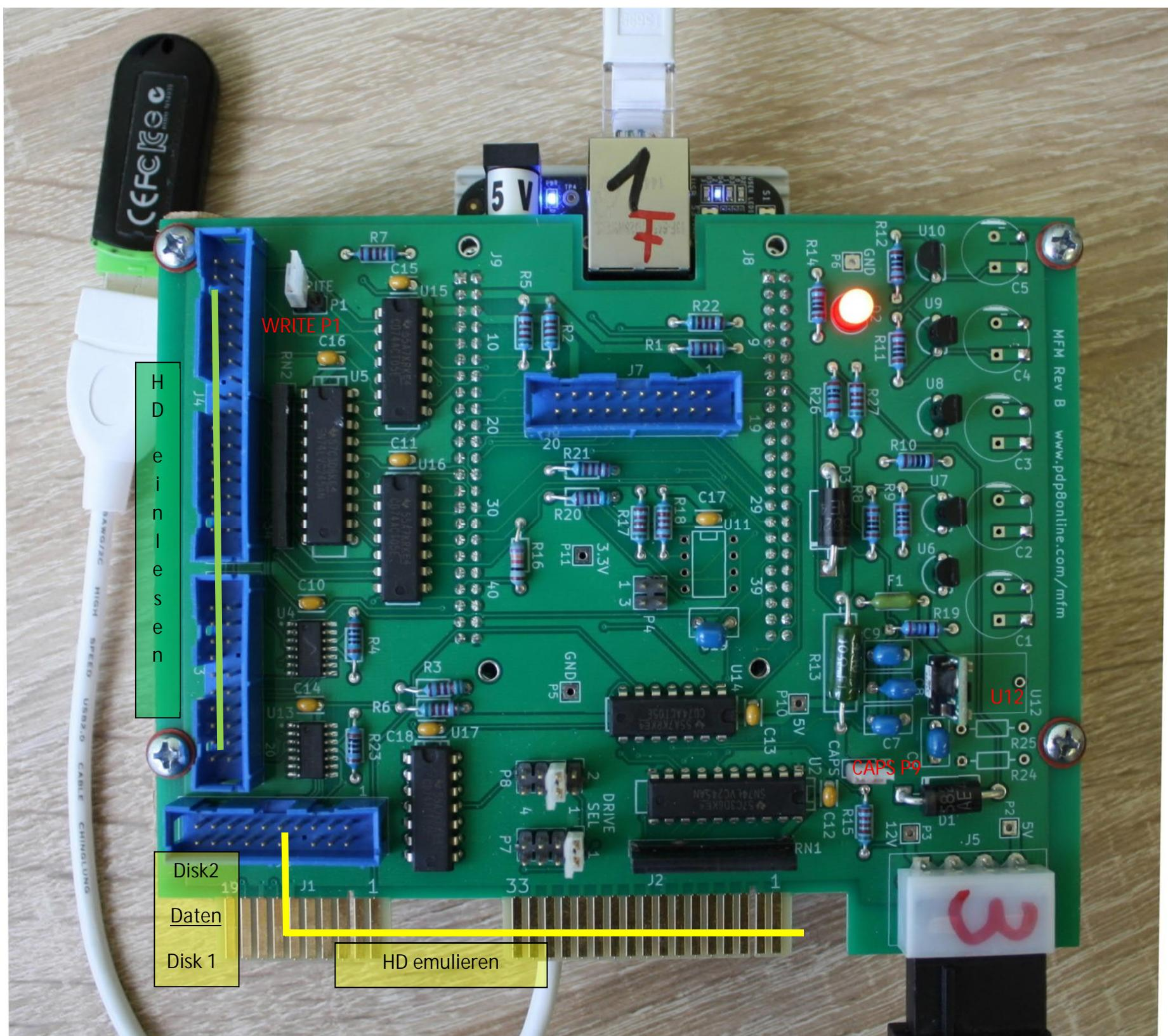
Bild aus einer HD Emulation mit NCR DMV (J9=CAPS ist hier nicht gesetzt, LED ist aus.)
