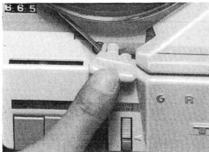
Bild 49. Benutzung einer Bandreinigungsgabel (Grundig)
