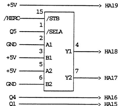
/HERC ist das bisherige Freigabe-Signal für die Hercules-Karte, dessen Verbindung zu HA18 (A18 des PC-Slot) getrennt wird und Q5, Q4 und Q1 sind Ausgänge des 74HCT-259-Latch (wobei Q1 bereits an HA15 und +5V an HA19 des PC-Slot liegen).
