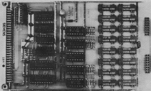
Für viele Anwendungen in der Industrie reicht der TTL-Pegel eines Mikroprozessors Parallelports nicht aus bzw. erfordert die Zwischenschaltung von Leistungstreiber Ferner ist oft ein potentialfreier Schalter gefordert, der sich nur mit einem Relais verwirklichen läßt.
