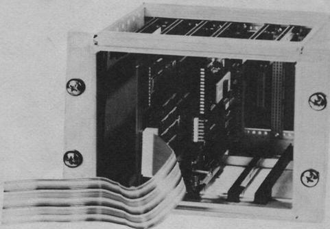
Kleinstsystem mit CPU, Serienschchnittstelle, 4K RAM, 4K EPROM und zwei 8 Bit Parallel-Ein/Ausgängen. Das Steuerungssystem wird geliefert auf zwei Europakarten, montiert in einem kurzen Rahmen auf einem 5'er-Bus, voll bestückt. Es können also noch drei weitere Karten nach Wahl hinzugefügt werden, z.B. noch 2x Relais-Output und 1x CTC o.ä.
