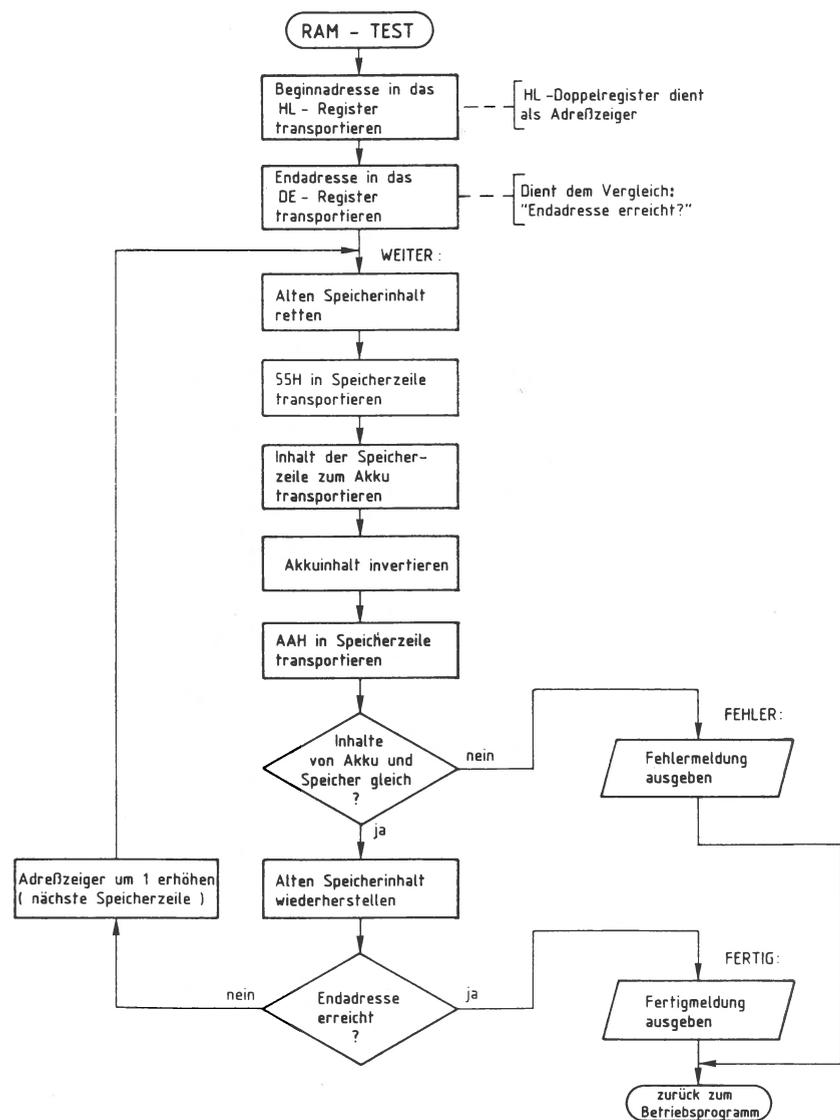
Bild 42: Prinzip des Flußdiagramms für ein Speichertest-Programm.
