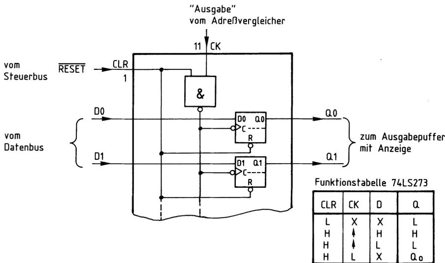
Bild 12: Der Ausgabespeicher und die Funktionstabelle des 74LS273.
