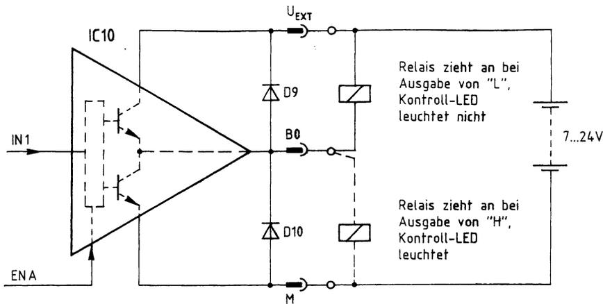
Bild 17: Der Anschluß der Freilaufdioden.
