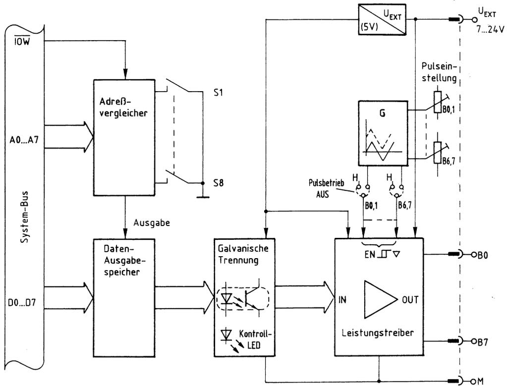
Bild 16: Das Blockschaltbild der 8-Bit-Parallel-Ausgabe mit galvanischer Trennung und Einsatz von Leistungstreibern.
