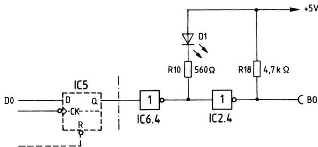
Bild 13: Der Ausgabepuffer mit Anzeige.
