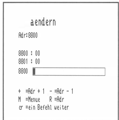
Abb. 6.1.8 Der Bildschirm zeigt jetzt vierstellige Speicherzellen-Nummern sedezimal an. Daneben nach dem Doppelpunkt auch den Inhalt. Das rechteckige Feld kann mit Befehlen an den Computer beschrieben werden
