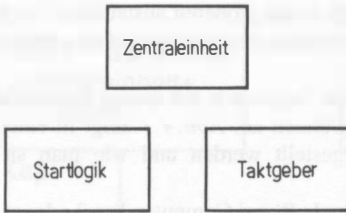
Abb. 4.1.1 Im Herzen des Computers arbeitet die Zentraleinheit (CPU). Sie wird von einem Taktgeber angetrieben und von einer Startlogik richtig gestartet
