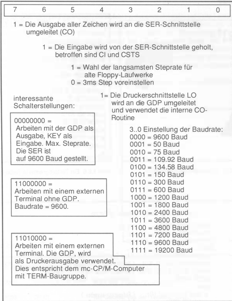
Abb. 8.6.4 Einstellung des DIL-Schalters auf der KEY-Baugruppe
